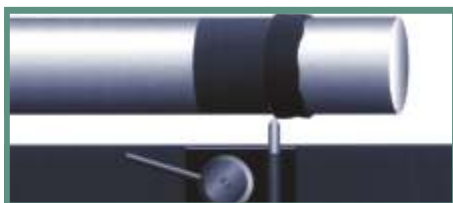
Maquine (tornee) el epóxico a la dimensión original del eje.
