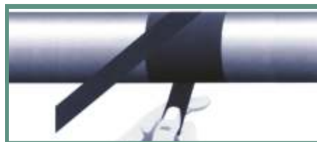
De ser necesario, pula la reparación con papel de lija.
