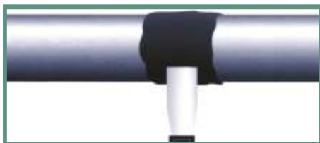
Rellene el área en reparación con el epóxico.
