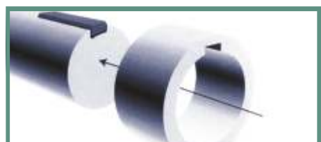
Alinee inmediatamente el chavetero, eje y casquillo.
