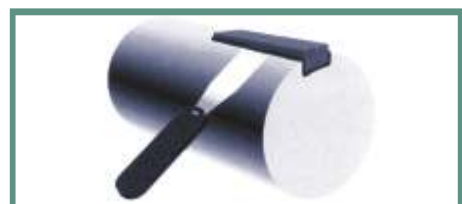
Retire inmediatamente el exceso de epóxico del área en reparación.
