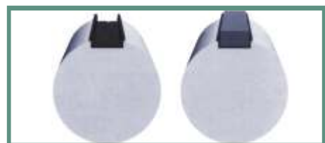
Llene el hueco del chavetero con epóxico e inserte la chaveta recubierta.
